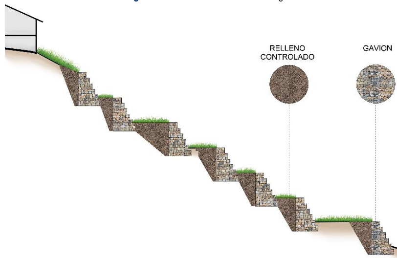
Imagen N° 75: Muro de contención con gaviones
